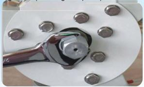
3, Instale la tuerca hexagonal en el centro del eje del rotor y atornille la tuerca de seguridad.
