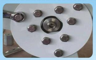
1, Monte la placa del hub y las palas en el cubo de la cuchilla, atornille la tuerca de seguridad. (Ver imagen superior).
