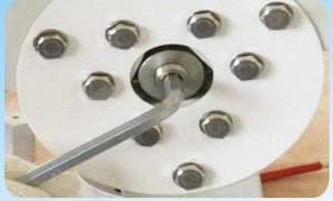
2, inserte una llave hexagonal en el eje del rotor. Con cuidado y lentamente "gire" las palas para asegurar completamente el hub al cuerpo de la turbina.
